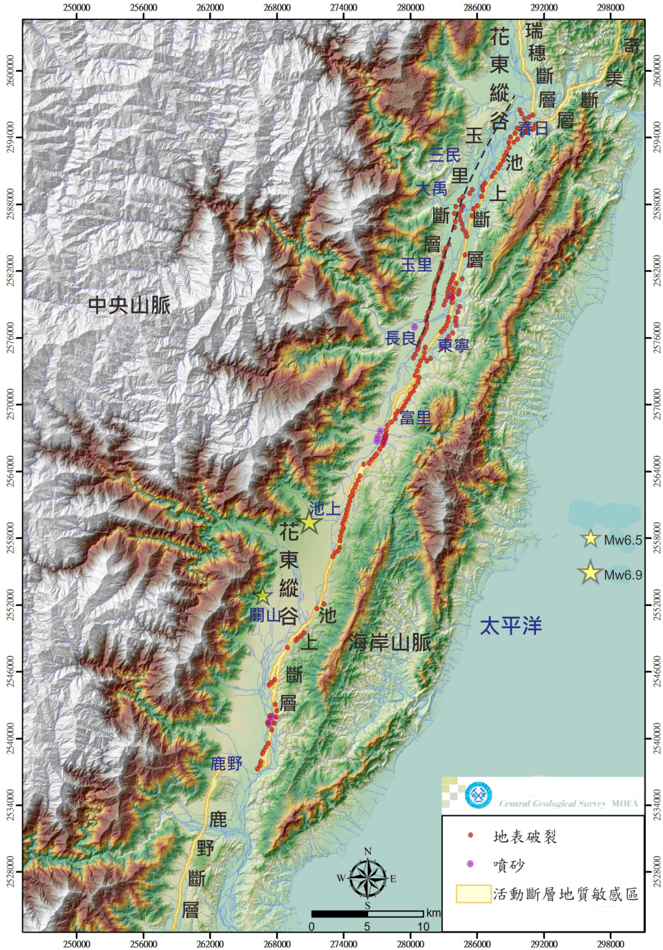
圖 1 2022 年 0917 關山地震與 0918 池上地震地表破裂位置。黃色星號為兩次地震的震央。紅色點為調查的地表破裂，紫色點為噴砂位置，黃色區域已經劃設為活動斷層地質敏感區的範圍。
